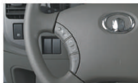
Cambio electrónico de 2WD a 4WD
