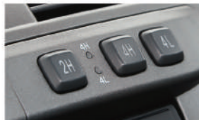
Cambio electrónico de 2WD a 4WD
